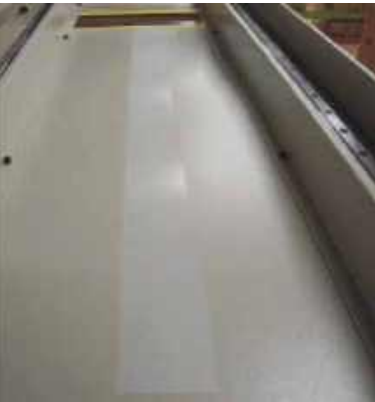
1. 在与拖链接触的工作台上面黏贴一层 PTFE
